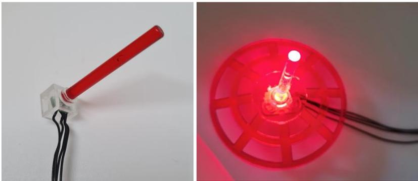
Abb 40: Modifiziertes LED Einbauelement mit durchbohrter Noppe
