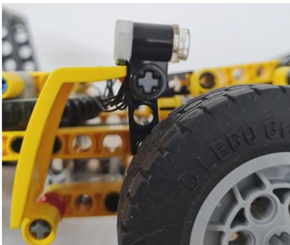
Abb 32: Eingebauter Scheinwerfer mit Kabelführung nach unten
