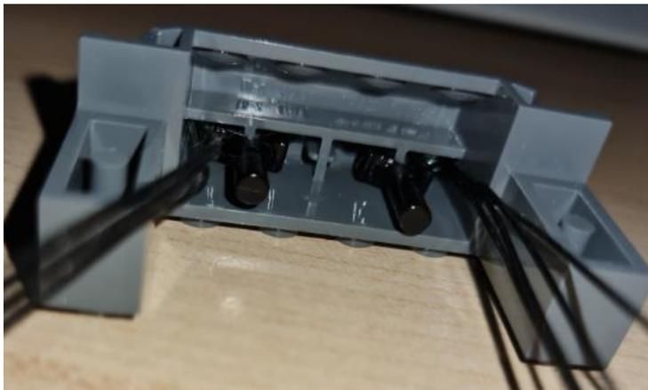
Abb 34: LED-Einsatz in Lok-Baustein mit Fixierung mittels Clips
