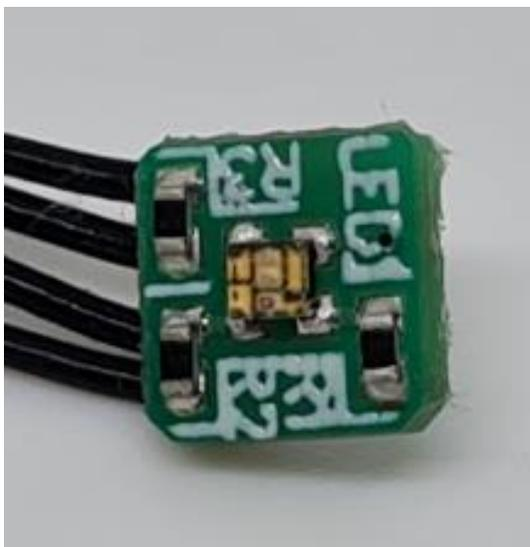
Abb 21: RGB LED-Platine im Detail
