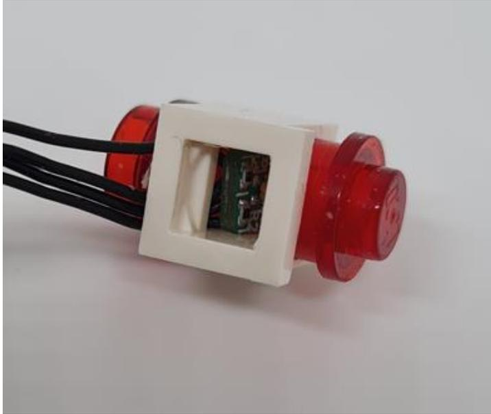
Abb 33: LED-Einsatz in Headlight-Element
