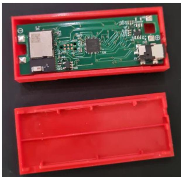
Abb 2: Geöffnetes Gehäuse des SBrick Light
