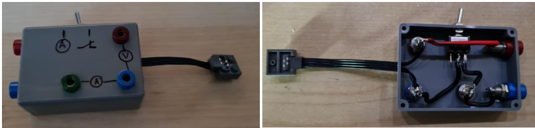
Abb 30: Meßbox für Power Functions Motoren
