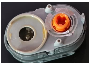
Abb 17: Getriebe und Kontaktplättchen des Winkelencoders
