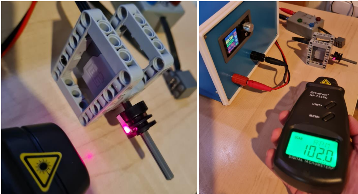
Abb 31: Reflektoren auf Felge und Messung
